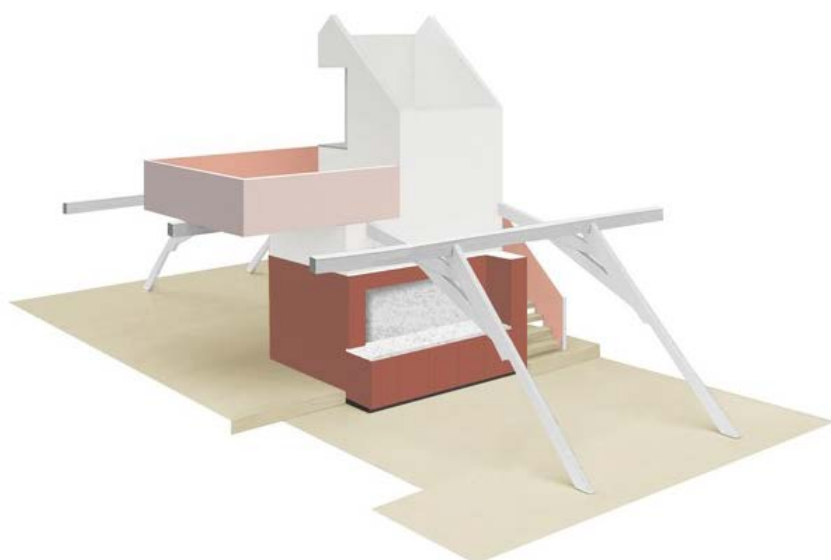
Freistehender Wohnkörper im Dachgeschoss
